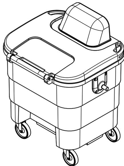
Diseñado bajo norma EN 840-2
